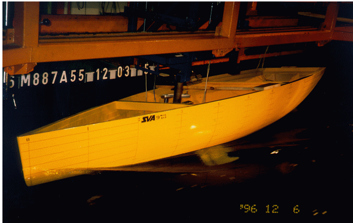
Bild 1: Modellversuch mit dem Segeldynamometer
