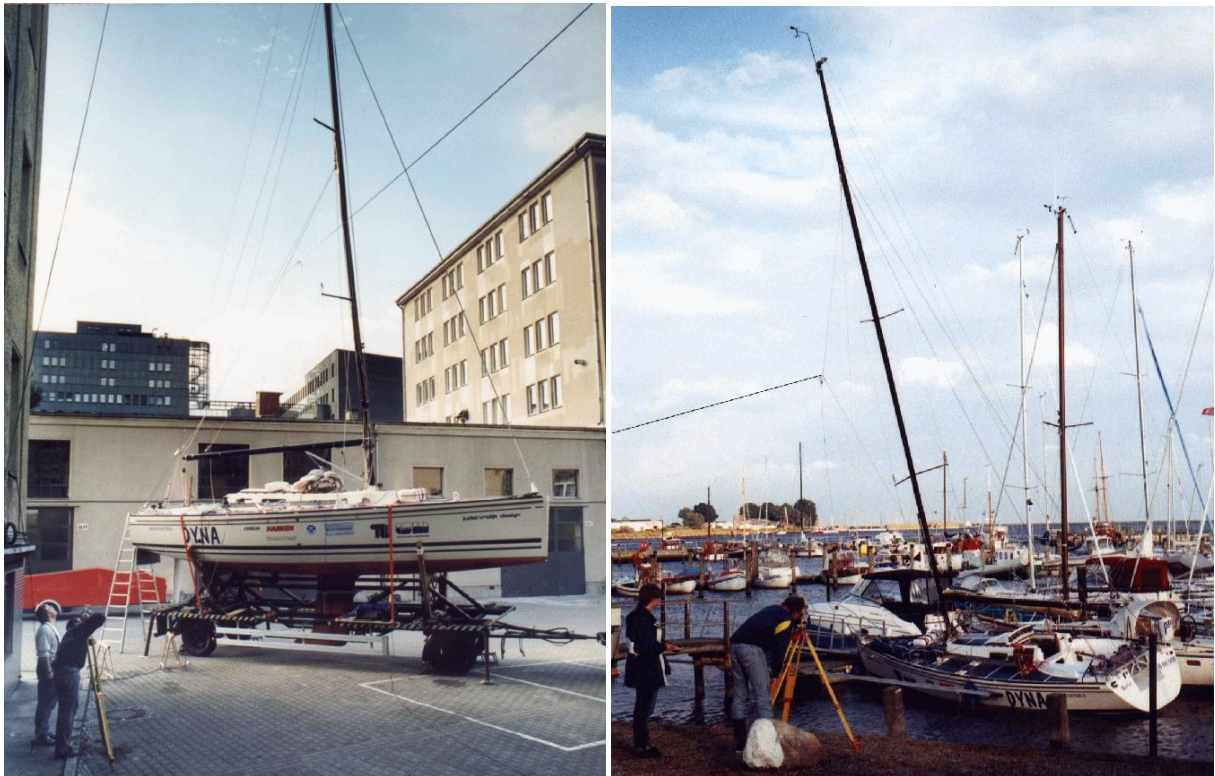
Bild 3: Kalibrierung der Riggwaage mit Messungen an Land und im Wasser
